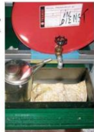
Салфетки OP разложены под резервуарами и маселами для сбора возможных масел протечек
